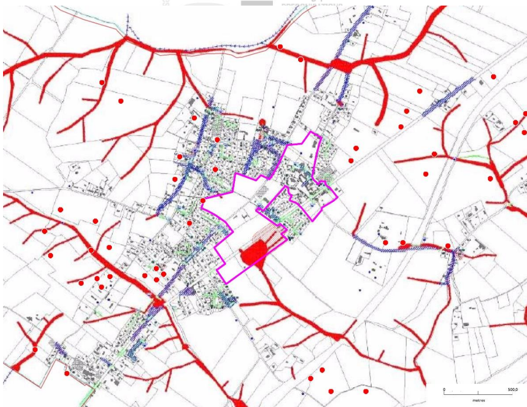
Figure 30 : Les ruissellements autour du périmètre de ZAC
